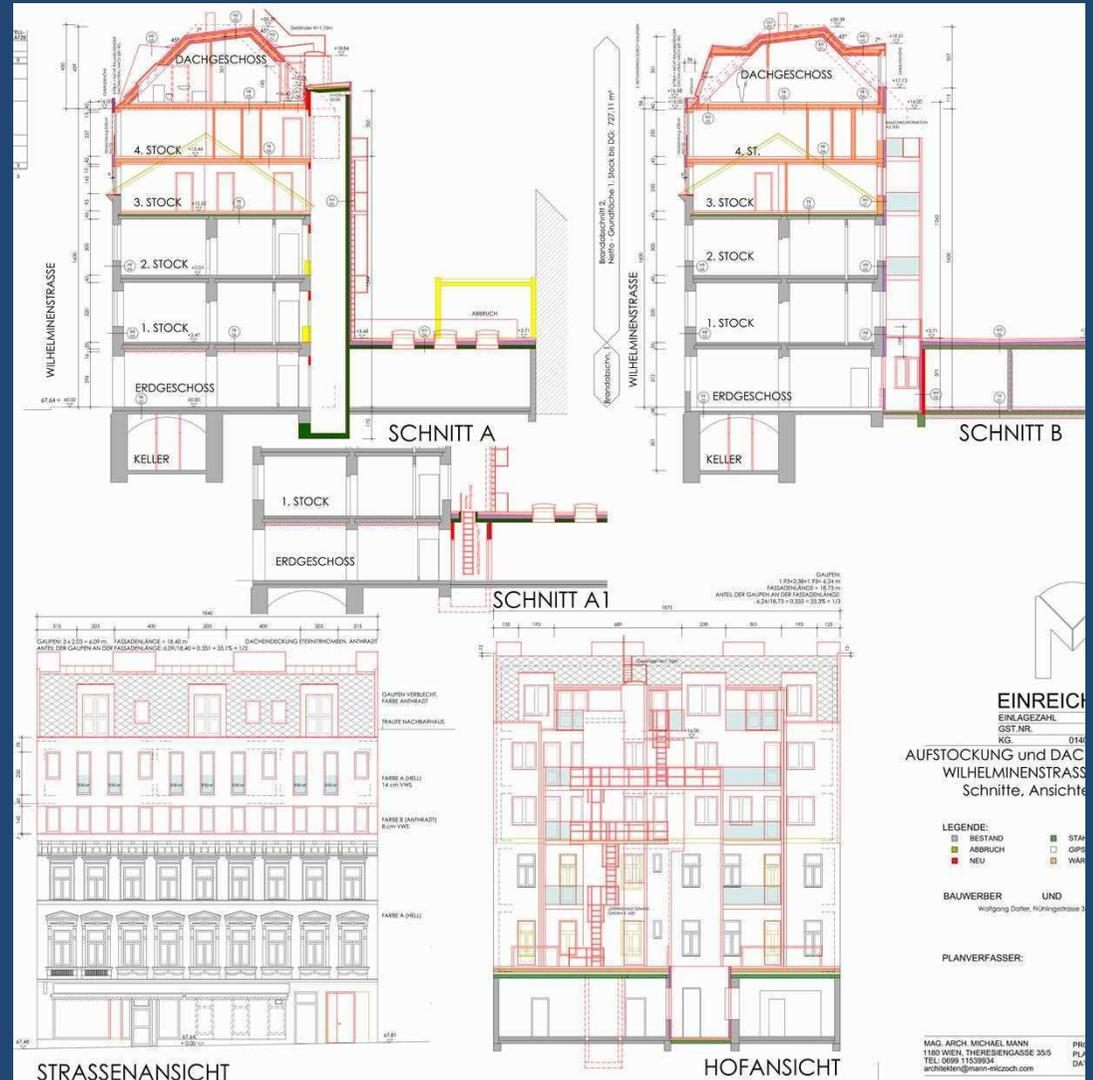
Sockelsanierung mit dreigeschoßiger Aufstockung, Dachgeschoßausbau. Lift- und Balkonanbau. Fünf neue, 4 verbesserte Wohnungen und 2 Lokale. Flachdachbegrünung. Fertigstellung 2022
